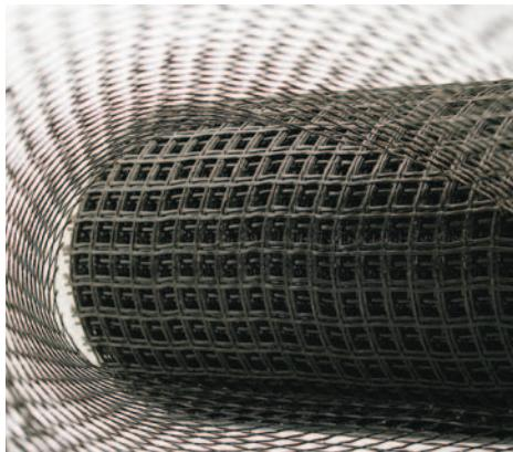
Базальтовая сетка – прочный, надёжный, долговечный материал на основе базальтового волокна, который применяется для соединения между собой наружного (облицовочного) и внутреннего (несущего) слоёв стены.
