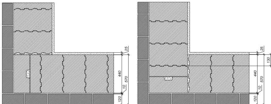
Из-за особенностей размеров блоков при кладке угла из Porotherm 44 необходимо использовать дополнительные элементы шириной 65 мм, выпиленные из цельковых блоков Porotherm 44.
