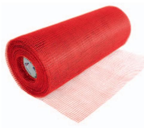
Кладочная сетка Porotherm JM укладывается в каждом ряду кладки из крупноформатных керамических блоков Porotherm с целью недопущения возможного проваливания кладочного раствора в большие пустоты, шириной более 10 мм.
