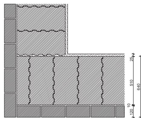
При кладке угла из блоков **Porotherm 51** рекомендуем использовать доборные блоки **Porotherm 51 ½**, которые позволяют избежать распилки блоков и возникающих в связи с этим неудобств. Обращаем внимание, что вертикальный шов, образующийся в месте соединения гладкой поверхности блока с пазогребневой стороной другого блока, нужно заполнить тёплым раствором во избежание образования щели или мостика холода.
