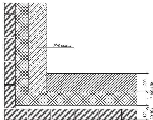
Для правильного устройства перевязки вертикальных швов рекомендуется использовать добротные блоки **Porotherm 20 ½** заводского изготовления.
