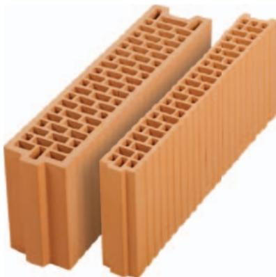
Крупноформатные керамические блоки Porotherm 8 и Porotherm 12 предназначены для кладки внутренних ненесущих межкомнатных стен в один ряд толщиной 80 мм и 120 мм соответственно. Минимальная толщина блоков Porotherm 8 и Porotherm 12 позволяет значительно увеличить полезную площадь помещения, сократить трудозатраты и расход раствора. Соединение вертикальных швов в паз и гребень также существенно ускоряет монтаж и экономит раствор.
