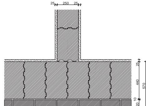
При соединении стены из блоков **Porotherm 25** с несущей внешней стеной один блок в каждом втором ряду выгibtывается на глубину примерно 130 мм для обеспечения перевязки внешней несущей стены с внутренней стеной из **Porotherm 25**.
